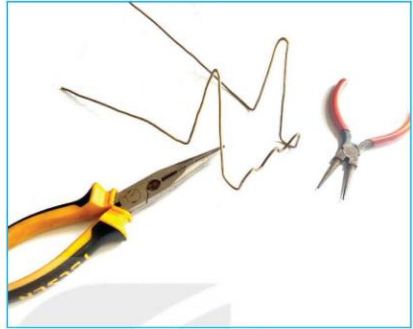
Bước 2. Sử dụng kim để uốn dây đồng tạo dáng sản phẩm
