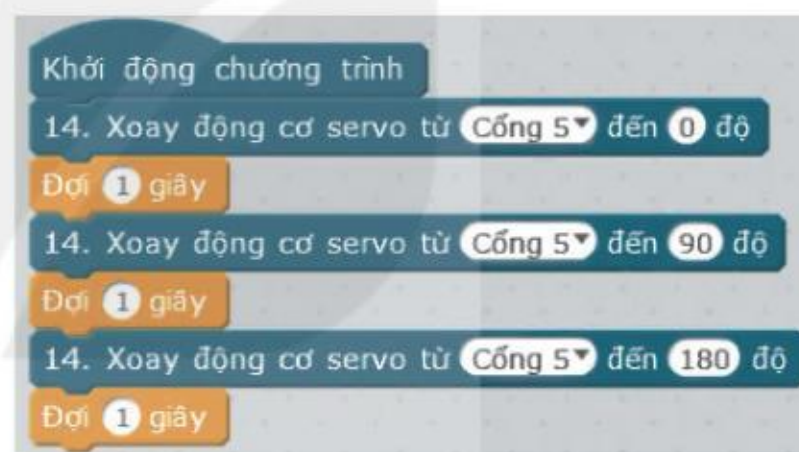
Hình 8.7. Chương trình kiểm tra động cơ servo
