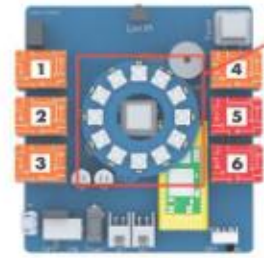
Hình 3.10. Đèn LED gắn sẵn trên bảng mạch điều khiển của robot
