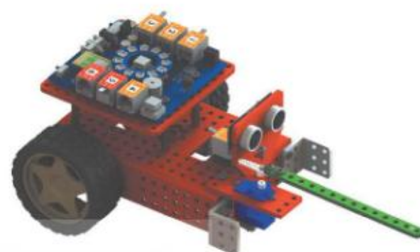
Hình 14.7. Robot sử dụng động cơ servo làm cơ cấu dọn dẹp vật cản
