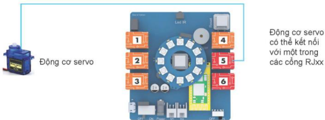
Hình 2.6. Sơ đồ kết nối động cơ servo với robot
