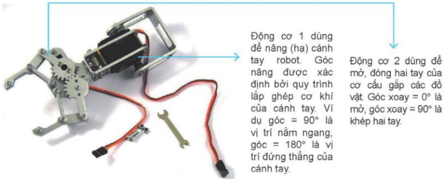
Hình 9.5. Mô hình cánh tay máy hai bậc
