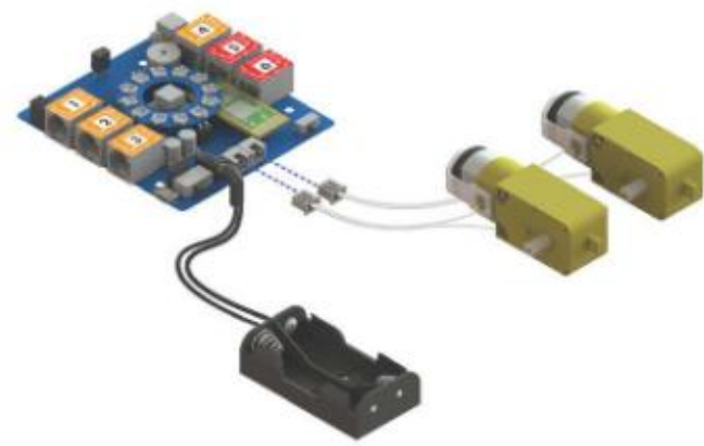
Hình 4.9. Kết nối bảng mạch điều khiển với động cơ M1 và M2
