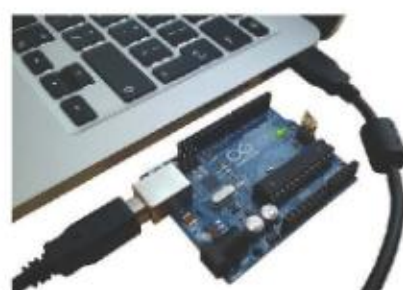
b) Cấp nguồn cho bảng mạch điều khiển qua cổng USB
