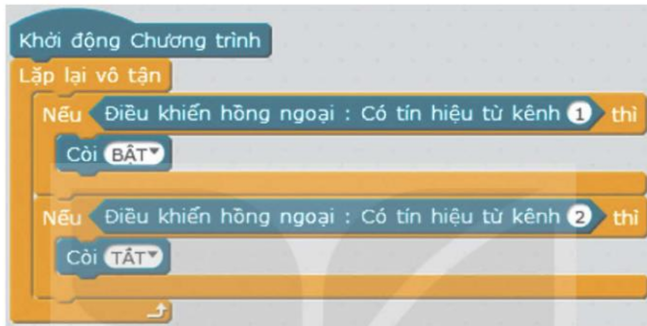
Hình 13.5. Chương trình kéo thả xử lý tín hiệu hồng ngoại
