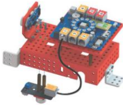
Hình 4.13. Lắp trụ đồng có gắn cảm biến dò đường vào thân 9×15 và kết nối với bảng mạch điều khiển
