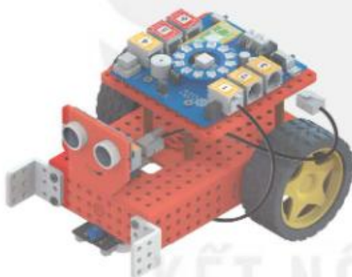
Hình 4.15. Cắm dây chuyển đổi siêu âm vào cổng số 3 trên bảng mạch điều khiển
