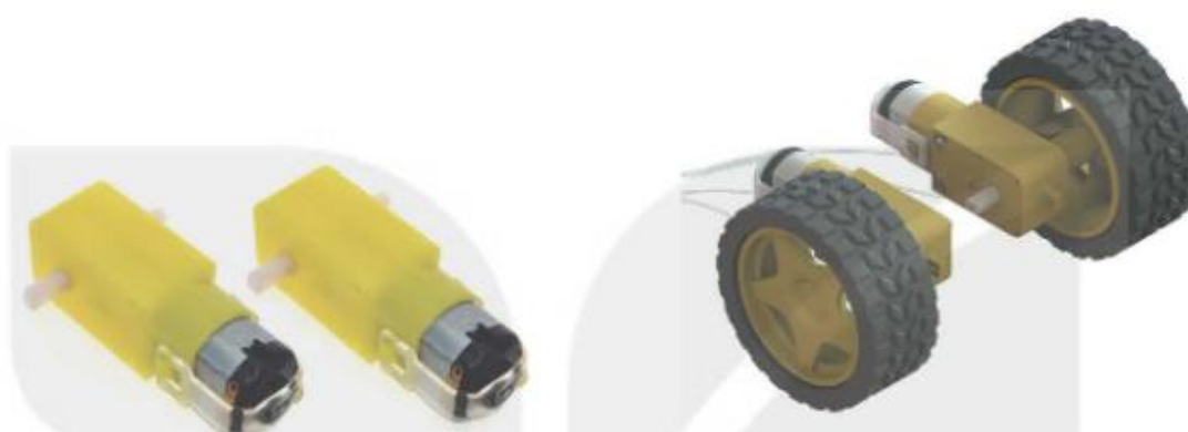
Hình 2.3. Động cơ DC và bánh xe giúp robot di chuyển
