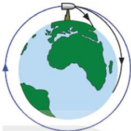
Hình 1.6. Mô hình mô tả ý tưởng phóng viên đạn chuyển động quanh Trái Đất của Newton
