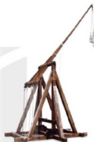
Hình 3.1. Máy bắn đá Trebuchet thế kỷ XII hoạt động bằng nguyên lý cơ học về lực đòn bẩy
