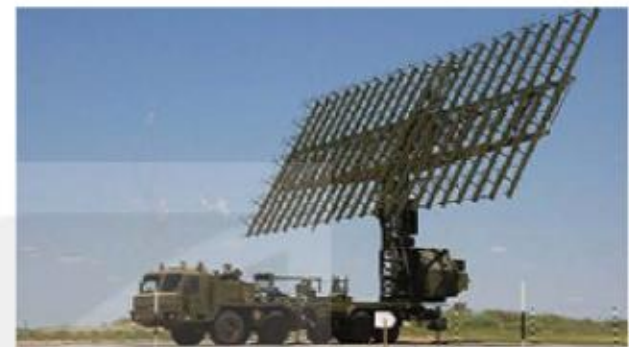
Hình 3.4. Tổ hợp radar cơ động Sopka của Nga sản xuất năm 2014, giúp phát hiện các mục tiêu khí động lực học và đạn đạo ở độ cao trung bình và độ cao lớn
