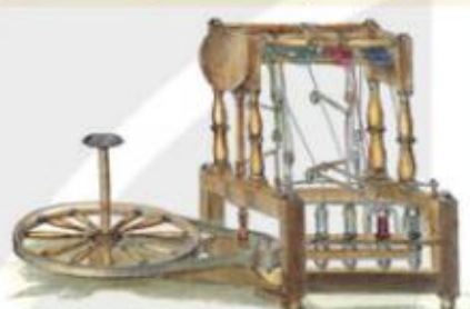
2.2. Máy kéo sợi chạy bằng sức nước (Ri-chác Ác-rai)
