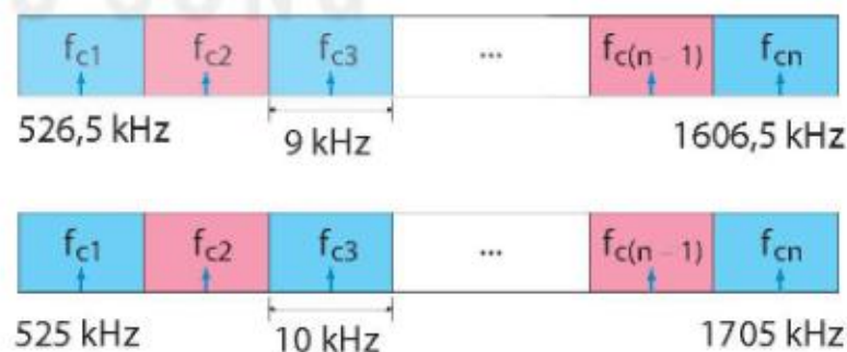
Hình 4.4. Cấp phát băng tần cho AM
