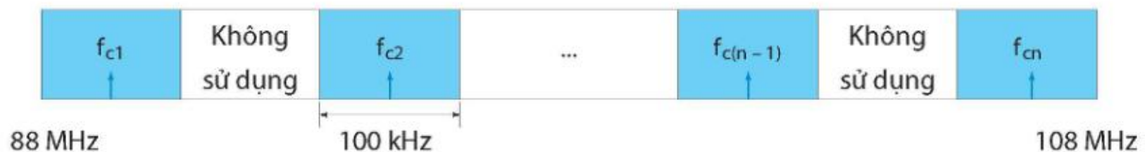
Hình 4.8. Cấp phát băng tần FM
