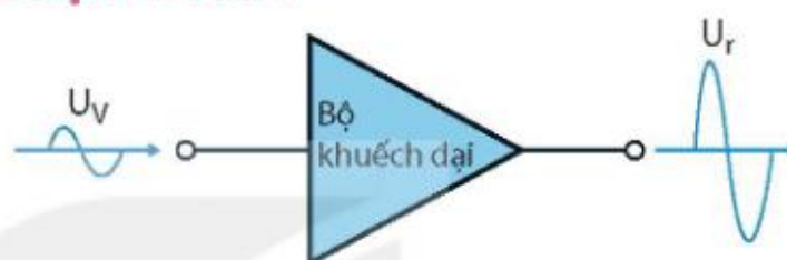
Hình 8.1. Tín hiệu điện áp trước và sau khi được khuếch đại
