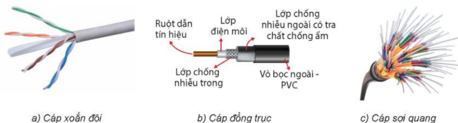
Hình 6.3. Các loại cáp truyền dẫn
