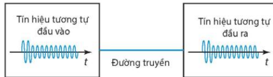
Hình 5.4. Truyền dẫn bằng tín hiệu tương tự
