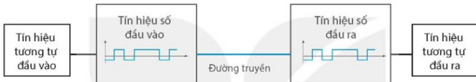
Hình 5.5. Truyền dẫn bằng tín hiệu số
