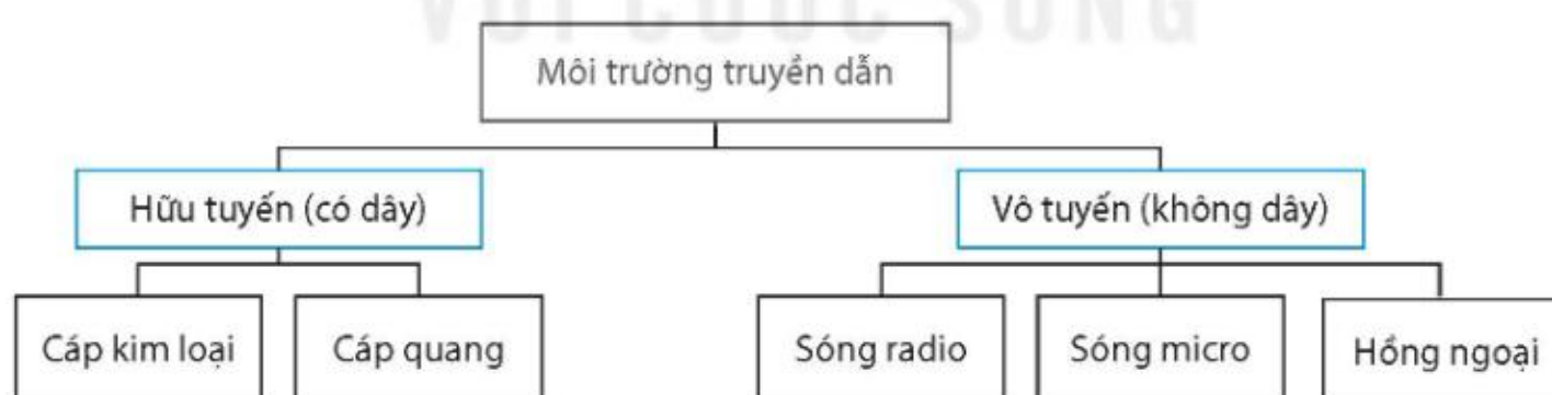
Hình 6.2. Phân loại môi trường truyền dẫn
