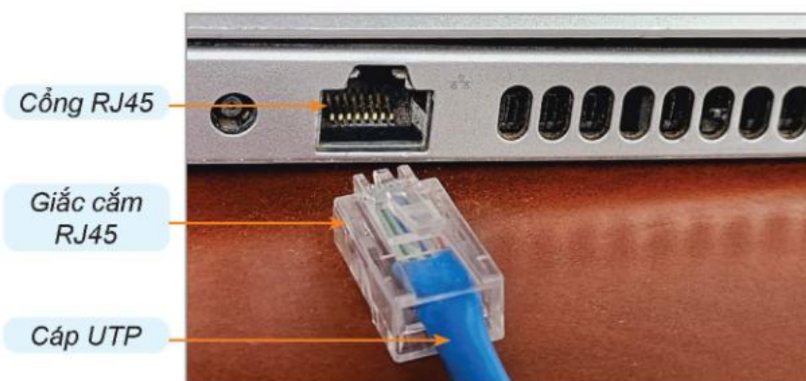
Hình 3.8. Giắc cắm và cổng RJ45
