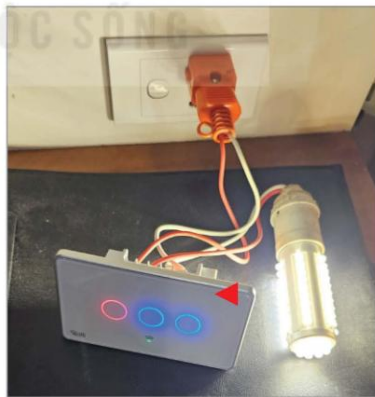
Hình 22.14. Giao diện cấu hình và điều khiển thiết bị với trạng thái bóng điện gắn với công tắc thứ nhất đang bật
